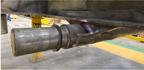
Estado del eje, previo a la soldadura
